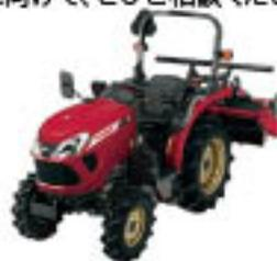
ノークラッチ仕様を採用しており、ブレーキ停止・発進もクラッチ操作が不要で、坂道やほ場の出入り口でも安心して操作できます。また、旋回時に自動で後輪内側に半ブレーキをかける「オートブレーキ」、前輪が後輪の2倍の回転数で駆動する「倍速」機能を標準装備しており、簡単な操作で小回り旋回ができます。
